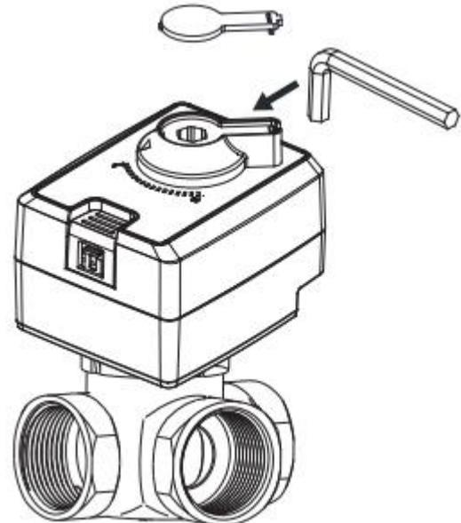
Если перепад давления высокий и рукоятка вращается тяжело, можно снять декоративную накладку с рукоятки управления и вставив шестигранный ключ на 10мм, увеличить плечо для облегчения поворота привода вручную.
